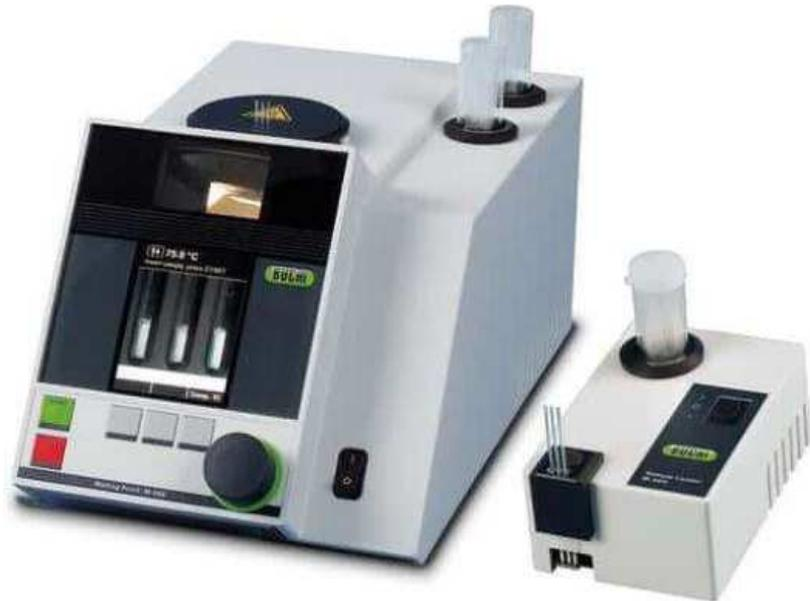
El Melting Point M-565 equipado con cámara de vídeo para la determinación automática de los puntos de fusión y ebullición está diseñado para el control de calidad profesional.
