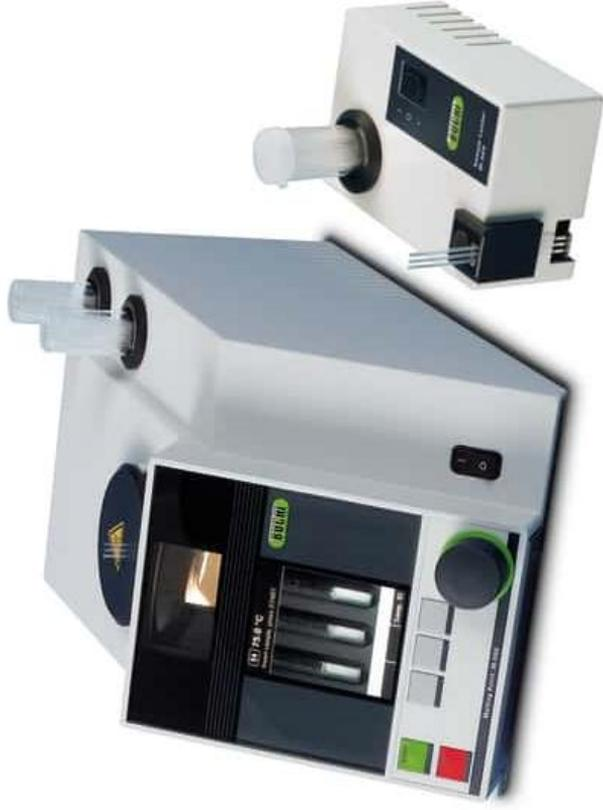
El Melting Point M-565 equipado con cámara de vídeo para la determinación automática de los puntos de fusión y ebullición está diseñado para el control de calidad profesional.
